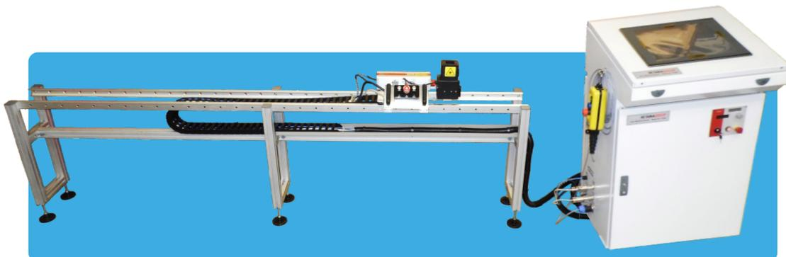
Für dieses Modell ist der Laserkopf auf einem selbstgesteuerten Schienensystem und auf Kundenspezifischen Höhe und Breite montiert, in der Regel wird es jedoch auf der Höhe des Ofenseingangs aufgebaut.
