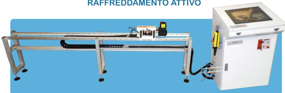
Per questo modello, la testa laser è montata su una struttura provvista di un binario guida, costruita secondo le esigenze tecniche e le specifiche del cliente, ma generalmente in funzione delle dimensioni e della posizione del forno.
